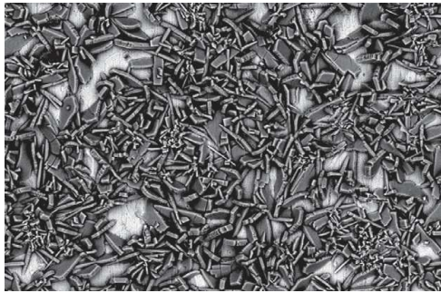
板金上のリン酸亜鉛粒のSEM画像
