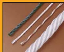
**Multifilamentos:** de PA, PES, PP, DYNEEMA, aramida, fibra de vidrio, rayón.
