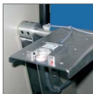
Sensor hilo roto o salto de cursor. Yarn break or traveller jump sensor.
