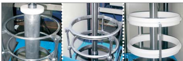
Anillo de control adecuado al tipo de material a elaborar. Anti-balloon ring depending of work material.
