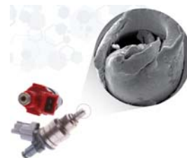
ノズル内部に残留し燃料 フローを妨げている異物
